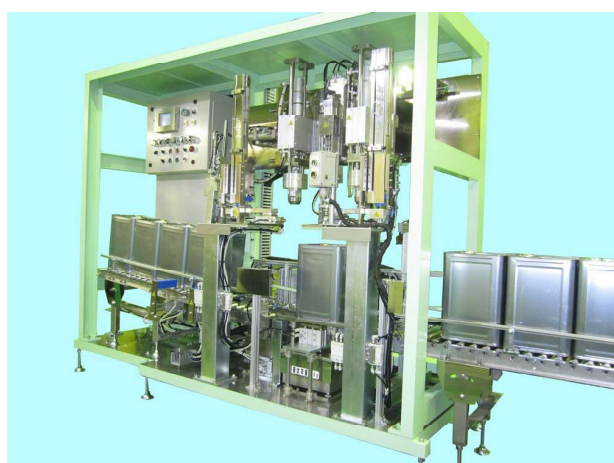
■ 18L角缶(#40/#50)自動充填・蓋締機 (充填・キャップトラバース)
