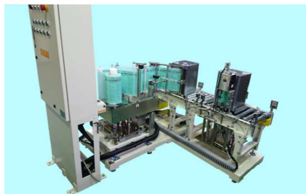
■ 18L缶用自動ラベラー (防爆仕様) (流れ貼り方式/ナンバリング付)
