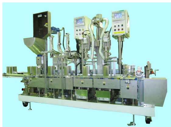
■ 自動充填・蓋締機 (防爆仕様) (角小缶0.5~5L多品種)
