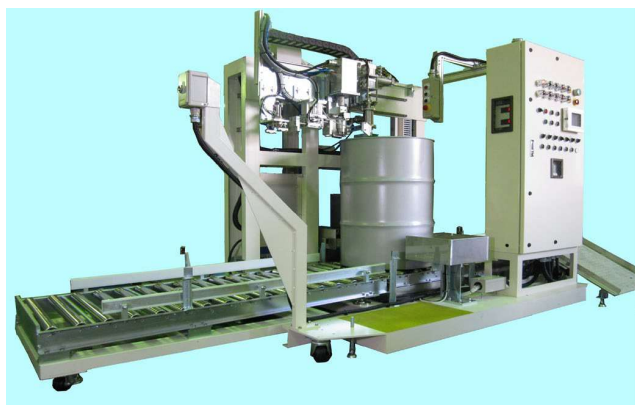
■ ドラム缶用自動充填機(位置決め・開閉栓自動) (防爆仕様)
