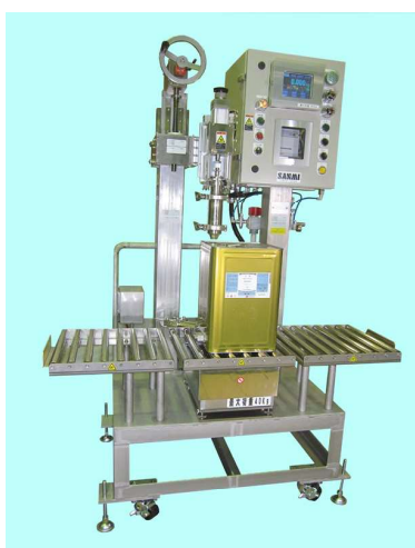
■ 半自動充填機 (防爆構造/データ記録)
