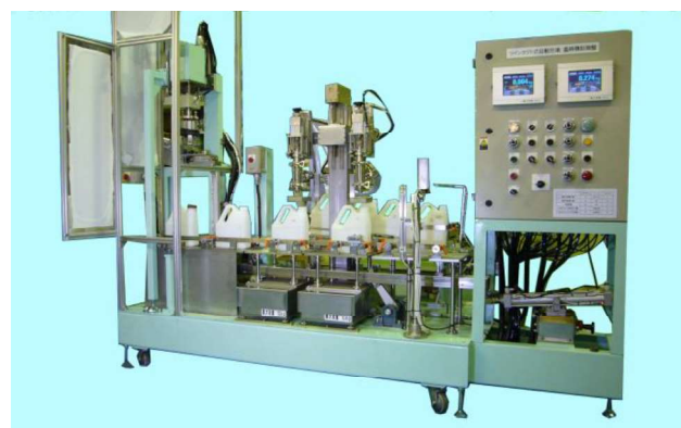
■ 自動充填・封緘装置 (ポリボトル)
