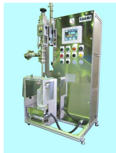
■ 小缶用半自動充填機 (1L角/丸容器、 0.3L角容器)
