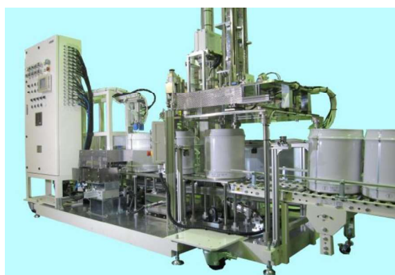
■ 自動充填・封緘装置 (18L角缶、20Lペール缶兼用)
