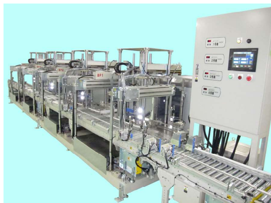
■ 缶内調色 自動ジャイロミキサーライン (4L丸缶、18L角缶)
