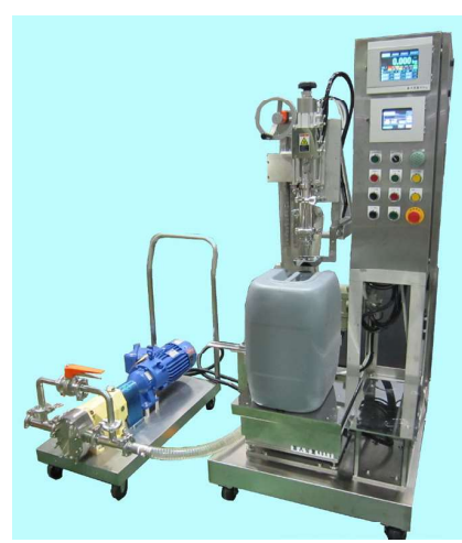
■ 多種容器兼用半自動充填機 (防爆仕様/ポンプ別置)
