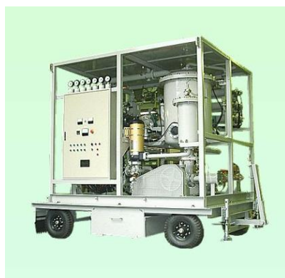
■ トレーラー付真空浄油機 絶縁油の真空脱気・脱水と油中の微粒子（コンタミ）を除去。 処理量：100ℓ/h ～ 20,000ℓ/h 各種 水分：50ppm → 7ppm以下（参考値） GAS分：10% → 0.1%以下（参考値） コンタミ：NAS 7級（参考値）
