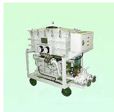
■ 密閉式油濾過機(SF型) フィルターによるコンタミ除去、アルソ(活性アルミナ)による油中水分の吸着で、油の耐電圧を上昇させます。能力：25ℓ～165ℓ/min
