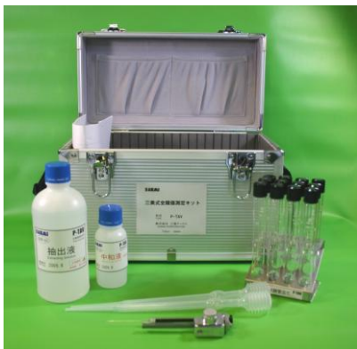
■ 全酸価測定キット P-TAV 絶縁油の全酸価を抽出／中和法で測定します。特定有害物質を含まず、測定終了は抽出液が鮮明な赤色に変化することで判定できます。
