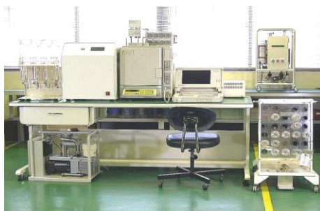
■ 油中ガス自動分析装置 絶縁油中に溶存しているガスの成分分析を自動で行ないます。ガス抽出、溶解ガスの特定、ガスクロによる決定、データプロセッサによる結果の分析を行ないます。
