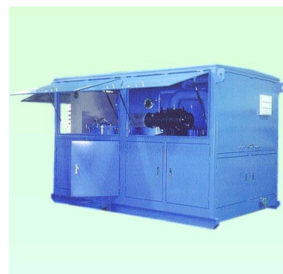
■ トレーラー付真空浄油機 絶縁油の真空脱気・脱水と油中の微粒子（コンタミ）を除去。 処理量：100ℓ/h ～ 20,000ℓ/h 各種 水分：50ppm → 7ppm以下（参考値） GAS分：10% → 0.1%以下（参考値） コンタミ：NAS 7級（参考値）
